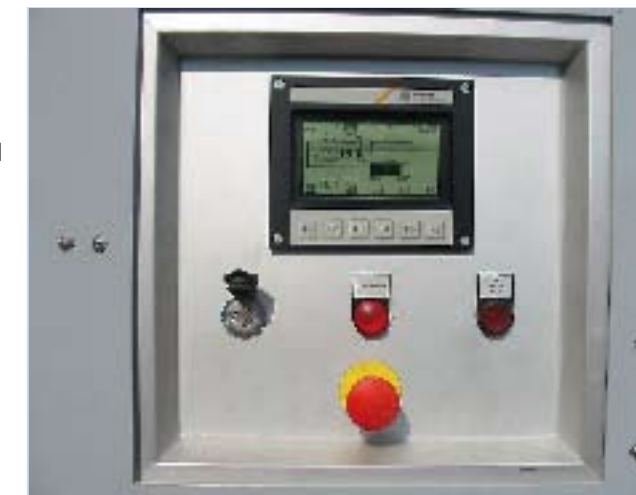
Proste sterowanie z płynną, automatyczną, regulacją ciśnienia uzależnioną od prędkości obrotowej silnika (jako opcja, dostępna wersja z obsługą manualną).
