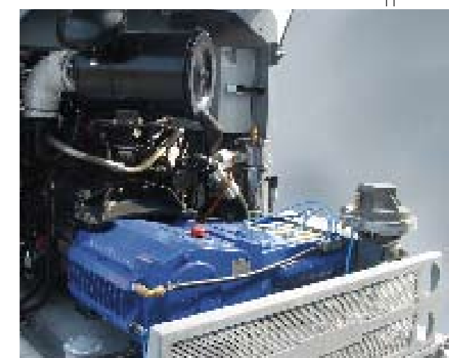
Pozioma konstrukcja wysokociśnieniowej, trójnurtowej pompy, zajmuje niewiele miejsca i niezwykle ułatwia prace serwisowe oraz konserwacyjne.
