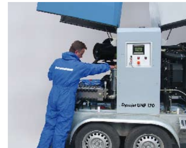
Konstrukcja dwuczłonowa: osobna komora obsługowa oraz serwisowa, gwarantuje łatwy dostęp do wszystkich ważnych elementów urządzenia.
